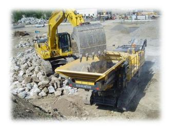
L'Opérateur d'installation sera chargé de traiter les matériaux issus de la carrière, pour en faire des matières premières élaborées et propres, grâce à une installation mobile de traitement composée d'un broyeur et d'un crible. L'installation fixe de traitement située sur un autre site est composée d'une chaine primaire, secondaire et tertiaire.
